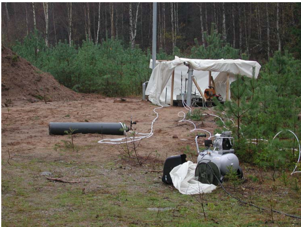
Foto 10 Inmatning av luft i cisternen från gasflaska. Kompressorn i förgrunden användes också.
