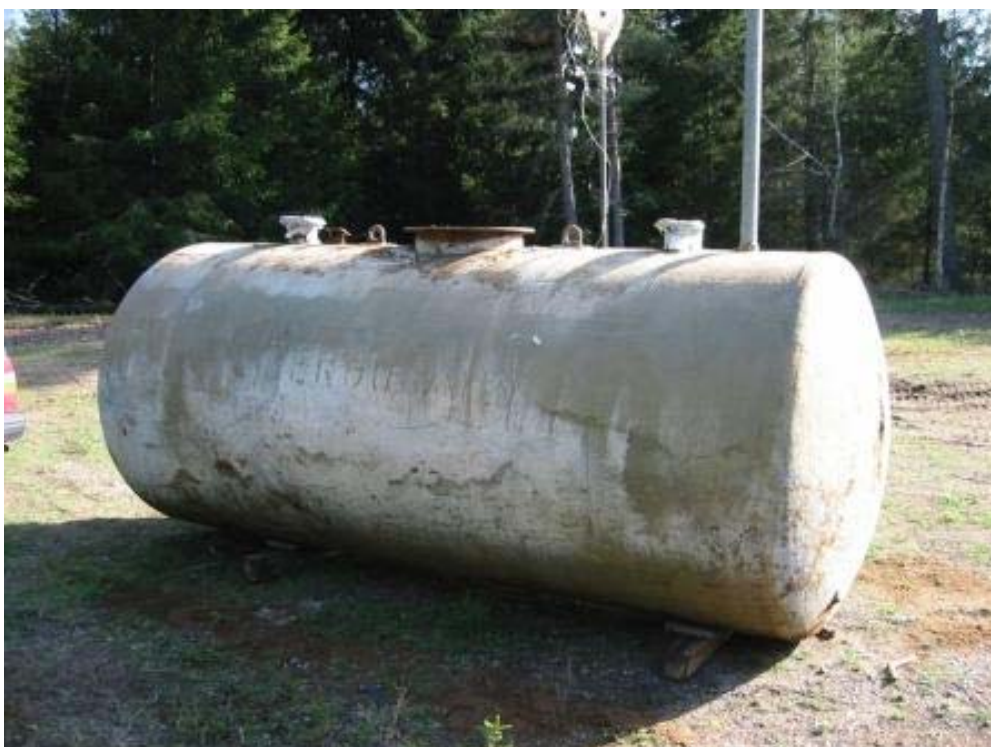
Foto 12 Cistern efter upptagning ur mark (07-05-07). Inga synliga skador kunde noteras.
